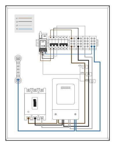
1. Identificare prima le fasi di ingresso. In circostanze normali, la fase marrone è il cavo sotto tensione L1, la fase nera è il cavo sotto tensione L2, la fase grigia è il cavo sotto tensione L3 e la fase blu è il cavo neutro N.
