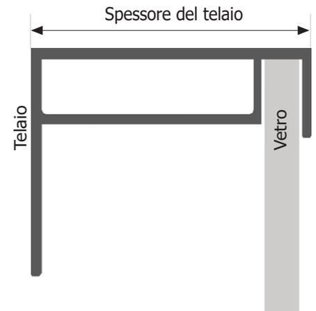
Se lo spessore del telaio è ≤35 mm (1,4 pollici), installare con l'etichetta TS4 rivolta verso il modulo fotovoltaico.
